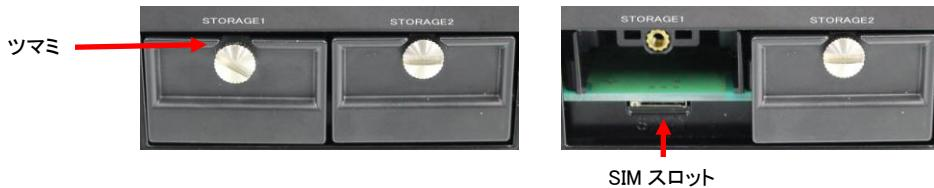
2. LTE用SIMカードの向きを確認し、SIMスロットに挿入します。カチッとした音が鳴るまで押込んでください
