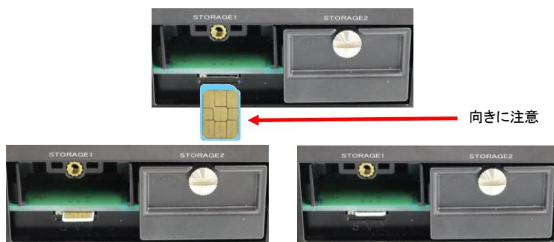
3. LTE用SIMカードを抜く際は、SIMスロットに差さっているLTE用SIMカードを奥まで押し込むとLTE用SIMカードがSIMスロットから出てきます
